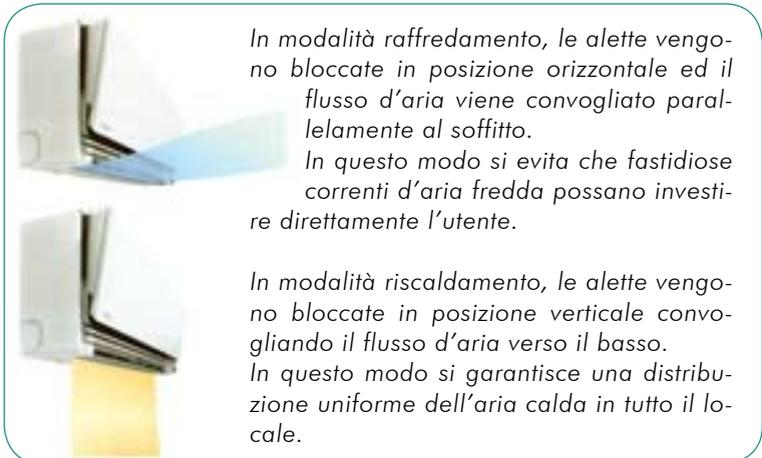
In modalità raffreddamento, le alette vengono bloccate in posizione orizzontale ed il flusso d'aria viene convogliato parallelamente al soffitto.
